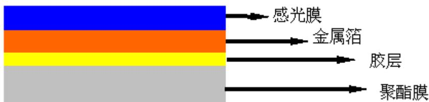
**曝光：**通过自动连续曝光机，自动对位曝光将菲林上的电路图性转移到感光膜上。截面图如下：
