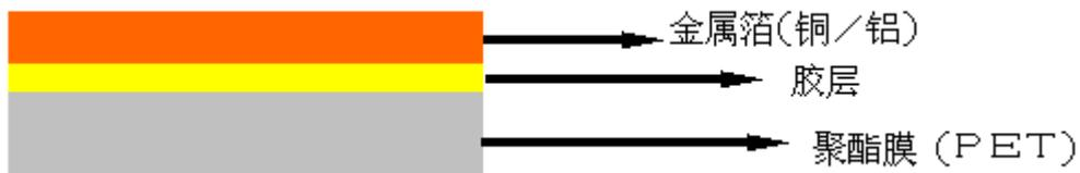
**贴感光感膜 / 印感光油墨：**通过滚压的方式将一层感光膜贴敷在基材的金属面；或在基材的金属面印上一层感光湿膜，经干燥后使用。材料的组成截面图如下所示：
